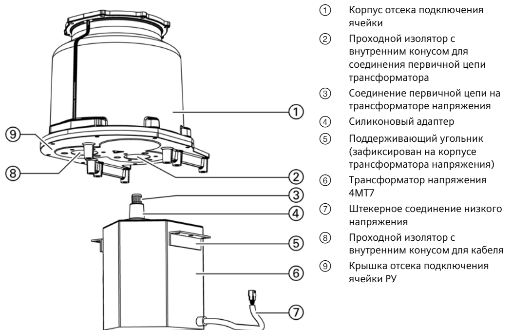
Рисунок 132: Трансформатор напряжения 4МТ7
