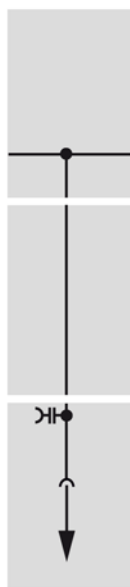
Ячейка кабельных соединений
