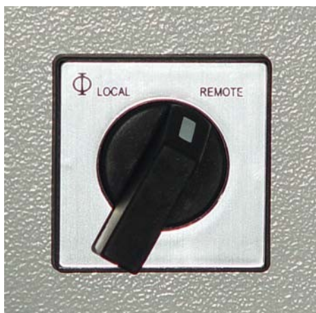
Рис. 37: Пример дистанционного переключателя, на рис. в положении дистанционного управления ("REMOTE")
