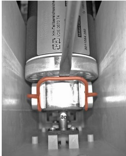
Рис. 158: Открытие обоймы с помощью отвертки
