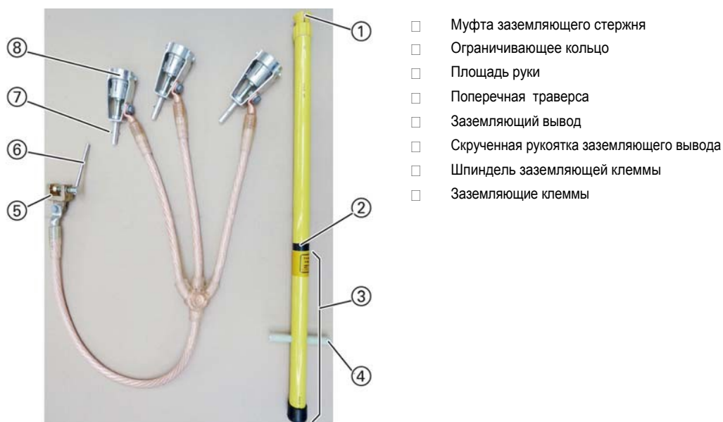
Рис. 150: Заземляющие аксессуары и заземляющий стержень (вместе доступны как вспомогательные аксессуары)
