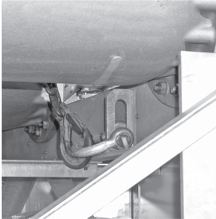
Bild 53 Anschlagpunkte am Rahmen
