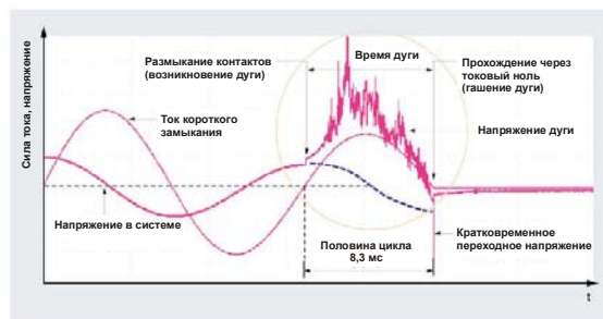
[Рис. 12-4] Пример осциллограммы, полученный в результате проверки на замыкание/размыкание при помощи резонансного контура LC.
