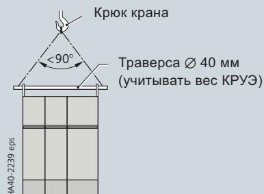
Транспортировка краном с помощью траверсы
